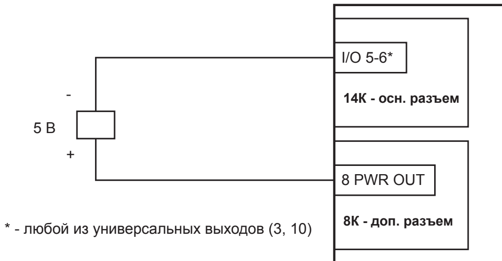
Рис. 3.12. Схема подключения реле к выходу (5 В)
