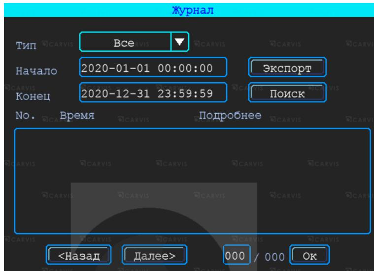
Доступны следующие значения: Все, Тревога, Исключения, Лок настройки, Настройка 3G, Система(флэш). Все события журнала кроме событий типа - Система(флэш) записываются на носитель данных (SD карту, HDD/SSD диск). События типа Система(флэш) записываются во внутреннюю энергонезависимую флэш память видеорегистратора. Доступны 250 записей (при переполнении записей старые записи перезаписываются на новые).
